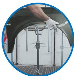
Mit dem Ständer können die Höhe und der Neigungswinkel des zu lackierenden Bauteils schnell und einfach eingestellt und angepasst werden. Durch die Einstellung des passenden Winkels laufen die Lackierarbeiten schneller und genauer ab.
