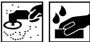
Entfernen Sie gründlich die etwaigen Korrosionsquellen und schleifen Sie die Oberfläche trocken mit Schleifpapier P320-P400. Untergründe und alte Lackanstriche nass schleifen mit P500-P600.
